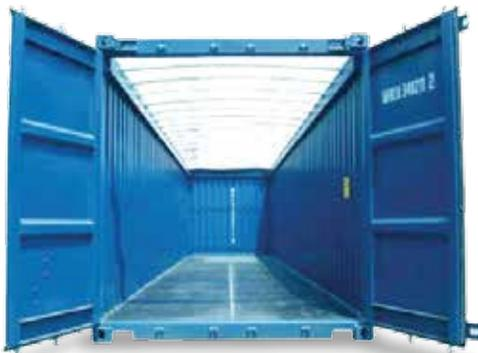
Este tipo de contenedor viene en las medidas del Dry Van y High Cube, diferenciándose de los anteriores por tener su parte superior descubierta, con el propósito de transportar mercancía que sobresale por sus características de tamaño, como maquinaria, vidrios, maderas, entre otros. El uso de estos contenedores tiene un costo adicional, porque no hay muchos de su clase en el mercado.
