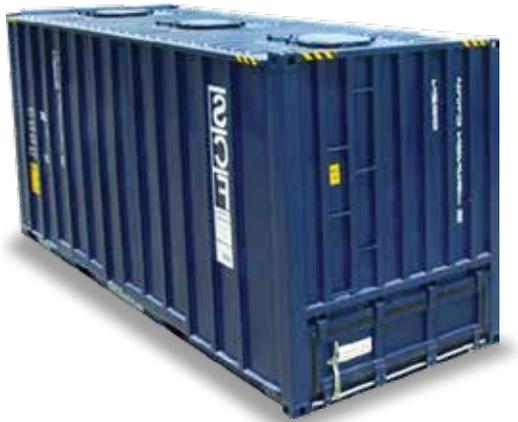
Diseñados para el almacenamiento y transporte de productos a granel. Cuenta con compuertas de carga en la parte superior para introducir el respectivo producto. Su principal uso está en el transporte de químicos, sal, azúcar, harinas, granos y demás.
