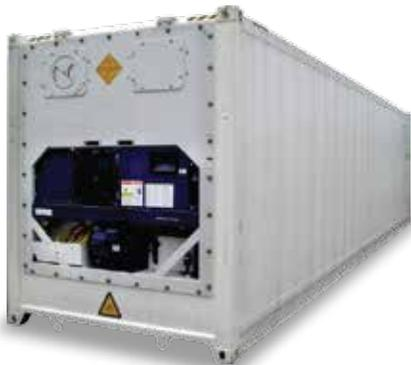
Esta clase de contenedores cuenta con un sistema de refrigeración que permite mantener temperaturas específicas requeridas para la conservación de cargas de productos perecederos como carnes, frutas y verduras, pero también puede ser usado para partes electrónicas o películas que necesitan una temperatura constante.
